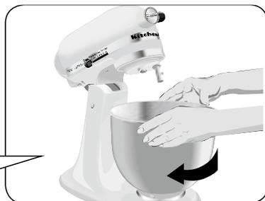
攪拌部品の取付部をアジテーター・シャフトにはめ込み、できる限り上に押し上げ、反時計方向に回してアジテーター・シャフトのピンに引っかけてください。
