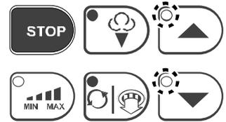
『▲』、『▼』スイッチを押して攪拌速度を変更してください。
