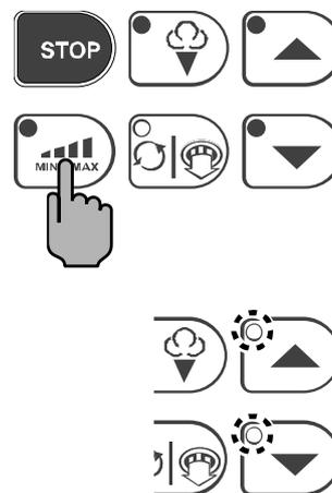
『▲』、『▼』スイッチを押して攪拌速度を変更してください。
